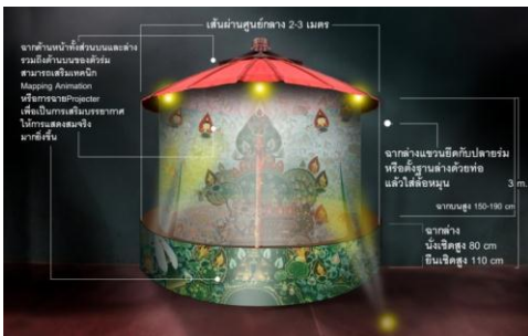
ภาพที่ ๗ ภาพร่างด้วยระบบคอมพิวเตอร์ เพื่อแสดงโครงสร้างงานนวัตกรรมโรงหุ่นกระบอกไทยด้านหน้า
